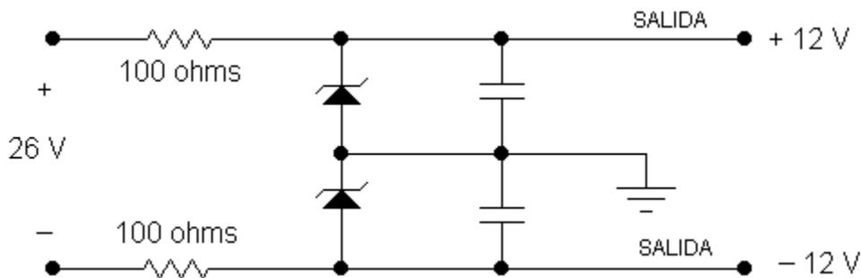
2. Ajusta la fuente de voltaje CD para un valor de 26 volts y conéctala con la polaridad que se indica en el esquema anterior.
